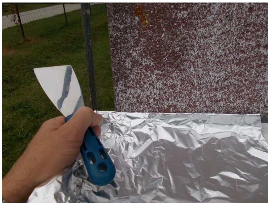
Obr. 20 Připravenou fólii přitiskneme jedním okrajem ke stavební konstrukci pod místem odběru.
