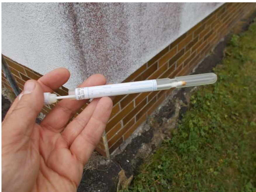
Obr . 12 Tampon s dokončeným stěrem vždy hned zasuneme do sterilní přepravní tuby.
