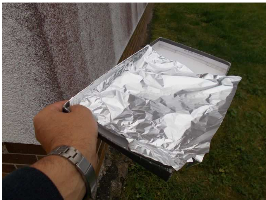
Obr . 19 V případech, kdy odběr provádí pouze jedna osoba, je vhodné pod zachytnou hliníkovou fólii použít pevnou podložku se zvýšeným okrajem. Folie se vždy použije tak, aby zachycený zorek dopadal na její (z hlediska návinnu) vnitřní stranu. Průběžně minimalizujeme kontakt folie s rukou a ostatními nesterilními předměty.
