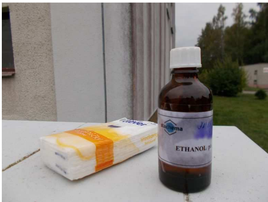
Obr . 14. Pro dezinfekci listu špachtle z leštěné nerezové oceli před odběrem postupem „obrus“ potřebujeme papírové kapesníčky a dezinfekční přípravek – etanol v koncentraci minimálně 60 %.
