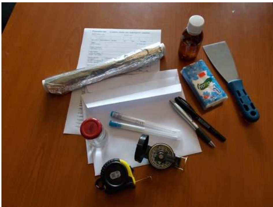
Obr. 1 Pracovní pomůcky a spotřební materiál pro provedení odběru vzorků kombinovanou metodou „stěr - obrus – stěr“
